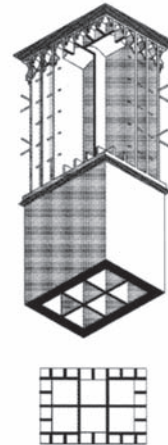
Axonométrie d'une tour des vents. Les ouvertures principales sont orientées selon la direction des vents dominants. © Hervé Richard et Shiva Toloüie
