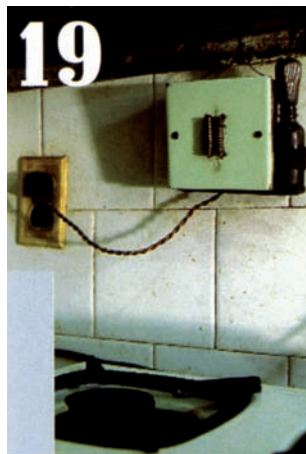
(19) (20) Allume-gaz électriques à alcool Création anonyme collective Principe technique: choc électrique par court-circuit Principe de fonctionnement: création d'une étincelle due à un court-circuit par frottement d'une tige sur un circuit ouvert. La tige en métal enfermant un textile imbibé d'un combustible prend feu. - Chez un particulier à Camaguey en 1999. - Chez un particulier, Santiago de Cuba, 1999. - Vendu dans la rue República à Camaguey en 1999.
